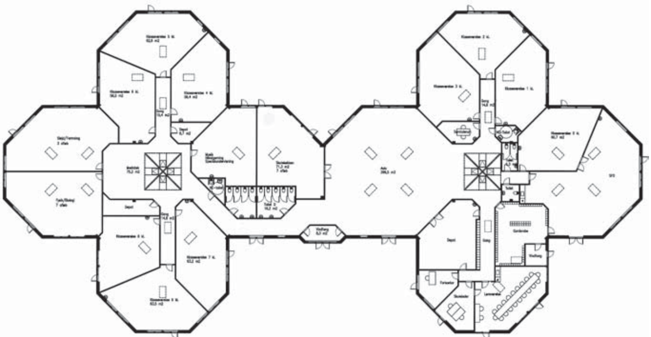
Plantegning over bygningskomplekset. Den niende oktagon er ikke med på tegningen. Den ligger for sig selv – og indeholder omklædnings- og baderum. Senere skal der i tilknytning til den opføres en hal til idræt og gymnastik.
